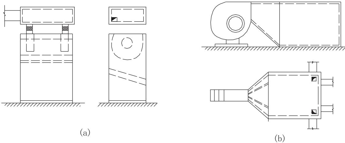
(a) Коробка для шумоподавления установлена на выходе кондиционера
